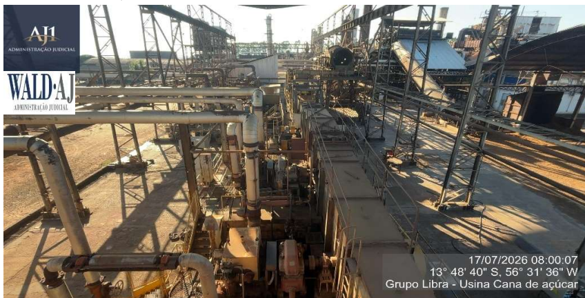
Figura 47 – Transportador De Correntes / Esteirao Estrutura Em Aco Carbono Pot Do Motor 50 Cv Dim 60000x1300x300
