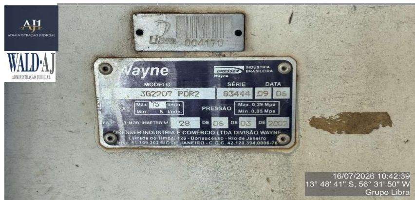
Figura 266 – Bomba De Combustível Vazão 50 L/Min Mca Wayne Mod 3g2207 P.
