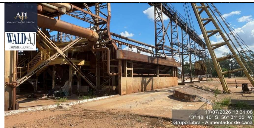
Figura 12 – Alimentador De Cana Tipo Mesa Estrutura Aco Carbono Dim 236000x5000x7000 Mm Mca Dz
