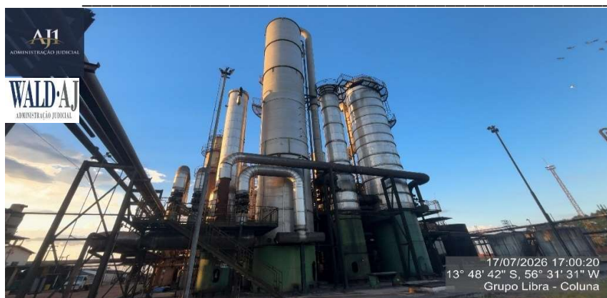
Figura 14 – 2 unidades de Coluna de destilação estrutura aco inox dim 4000x20000 mm cap 225935 kg m3/h mca engecorn mod lbr/10
