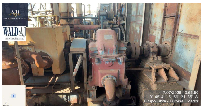
Figura 34 – Turbina do picador de cana pot 1500 w mca sebturbinas mod 800/3me
