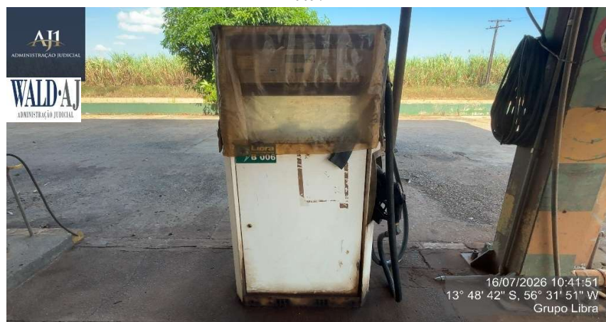
Figura 263 – Bomba De Combustível Vazão 50 L/Min Mca Wayne MOD 3G2207 P. – N ° B 006.
