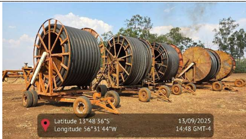
Figura 32 - Imagem do sistema utilizado na fertirrigação de vinhaça
