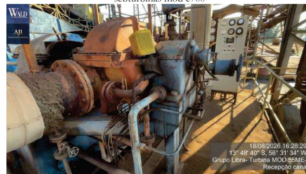
Figura 54 – turbina pot 960 hp mca sebturbinas mod 55 me
