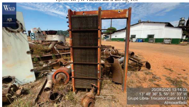
Figura 88 – trocador de calor estrutura aco carbono dim 600x600x1800 mm mca apv mod a085.br mgs-07
