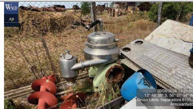
Figura 89 – separadora centrifuga estrutura aco inox 40 m3 mca westfalia mod hda50-06-506
