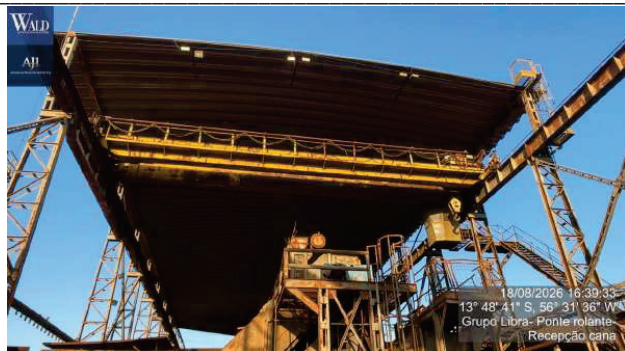
Figura 59 – ponte rolante cap 30 ton vao 10000 mm curso 100000 mm elevacao max 15000 mm
