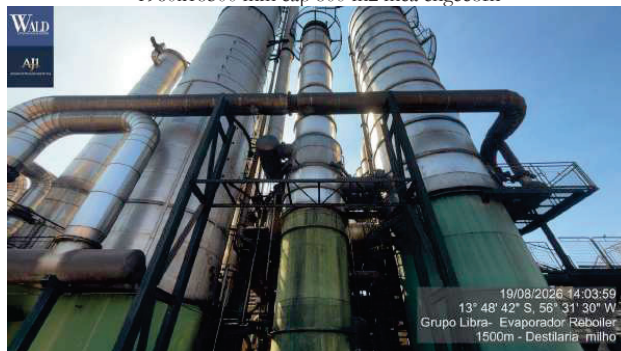
Figura 68 – evaporador reboiler estrutura em aço inox vertical dim 2350x20100 mm cap 1500 m2 mca engecom
