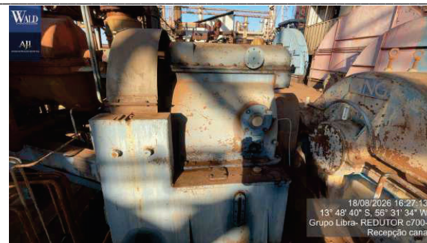
Figura 53 – redutor de velocidade paralelo c/motor pot 1350 kw relacao 3-3333 mca sebturbinas mod c700
