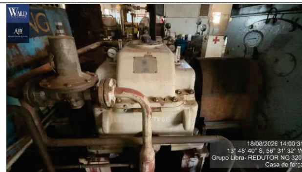
Figura 25 – redutor de velocidade relacao 4927-1800 mca ng mod g1d-320
