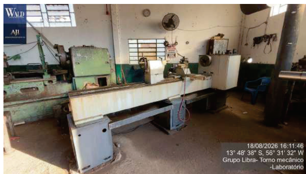
Figura 48 – torno mecanico horizontal diam da placa 300 mm comp 3000 mm c/1 fuso(s) mca nardini mod nd 325
