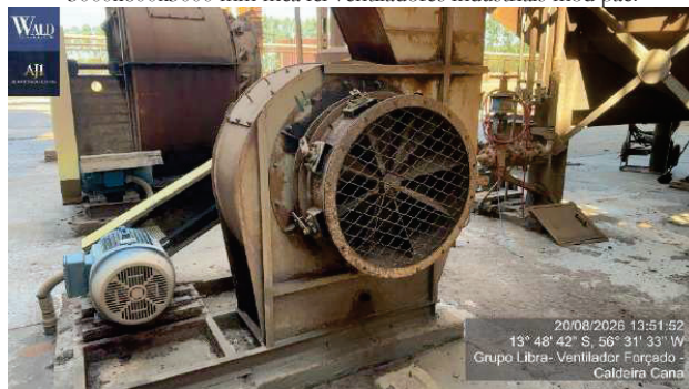
Figura 96 – ventilador centrifugo dim 2500x1200x2500 mm
