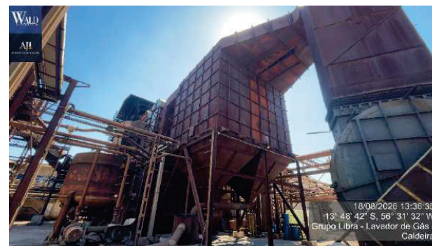
Figura 18 – lavador de gases estrutura aco carbono diam 6000x9000x9000 mm
