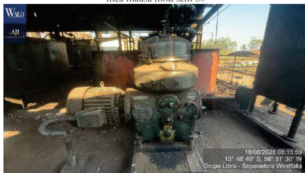
Figura 4 – separadora centrífuga estrutura aco inox 40 m3 mca westfalia mod hda50-06-506
