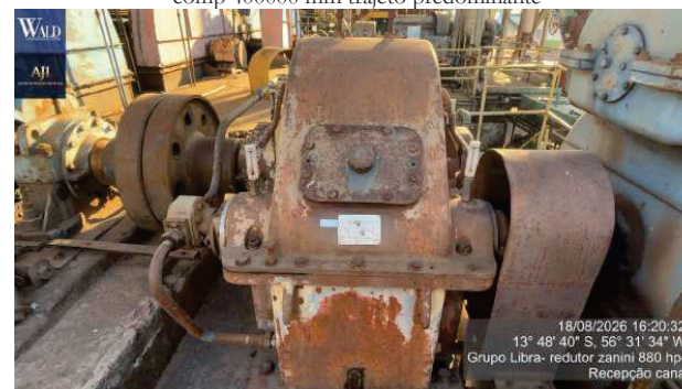
Figura 50 – redutor de velocidade c/motor pot 890 hp relacao 6-1.1 mca zanini
