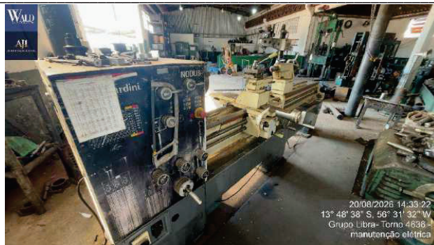
Figura 99 – torno mecânico horizontal diam da placa 600 mm comp 6000 mm c/1 fuso(s) mca nardini
