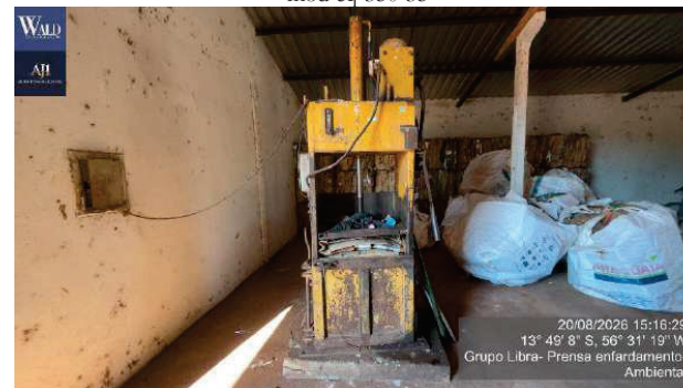
Figura 102 – prensa de enfardamento dim da mesa 600x400x1800 mm
