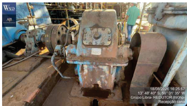
Figura 52 – redutor de velocidade c/motor pot 880 hp relacao 6-1.1 mca zanini
