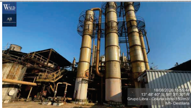
Figura 43 – 3 Unidade de coluna de destilacao i1 estrutura aco inox dim 1400x13000 mm cap 150 m3/h mca zanini mod zani-at
