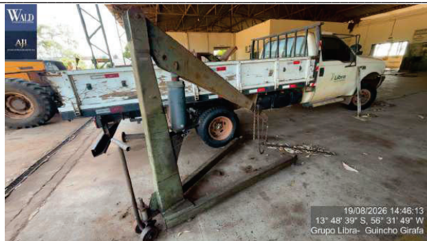
Figura 71 – guincho hidraulico tipo girafa cap 0.5 ton mca potente brasil
