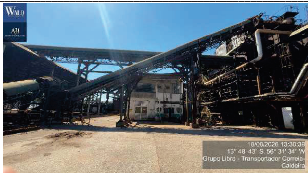
Figura 15 – transportador de correias estrutura em aco carbono c/esteira em lona vinilica pot do motor 30 cv dim
