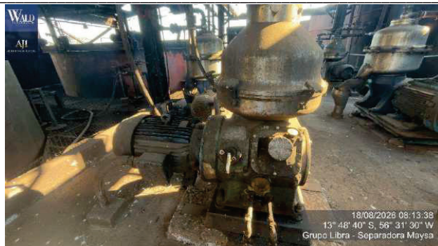
Figura 3 – 4 Unidade de coluna de separadora centrífuga estrutura aco inox 40 m3 mca mausa mod scm 50
